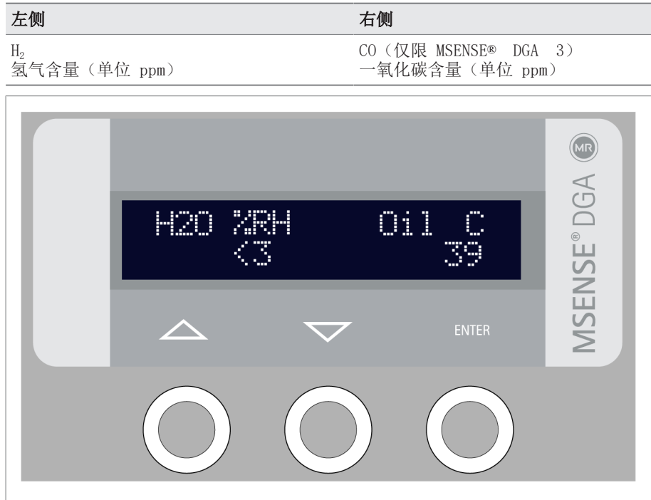
插图 42: 显示当前 H2O 含量和油温的显示屏
