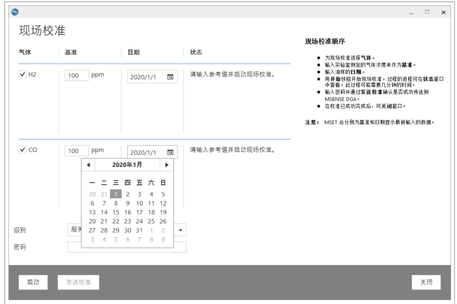
插图 52: 现场校准步骤 1
