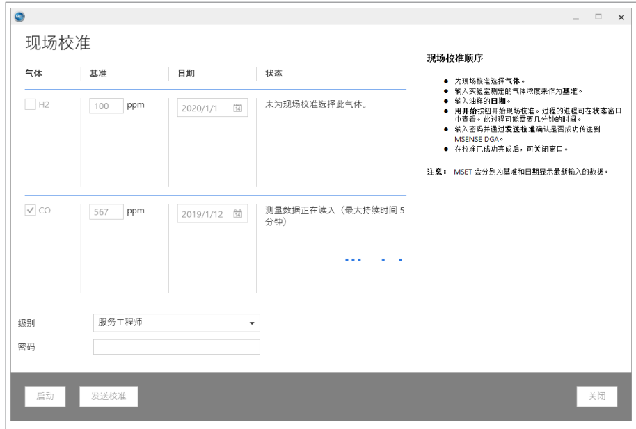
插图 54: 启动现场校准
